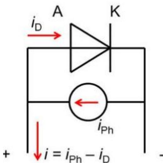
Slika 3.2. Solarna ćelija kao strujni izvor [6]
