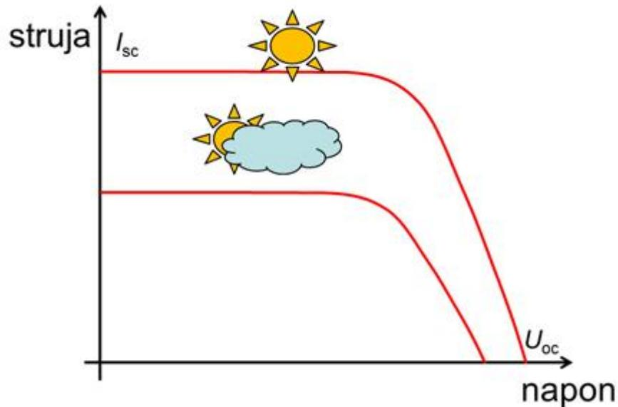
Slika 3.6. Karakteristika ne zasjenjene i zasjenjene solarne ćelije [6]
