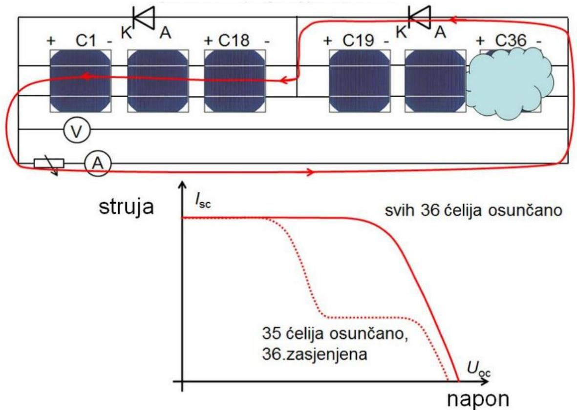
Slika 3.8. Spajanje prenosne diode [6]
