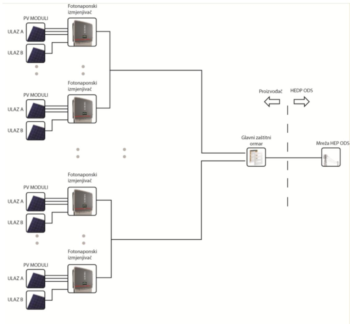
Slika 5.1. Principijelna shema solarne elektrane priključene na elektroenergetsku mrežu
