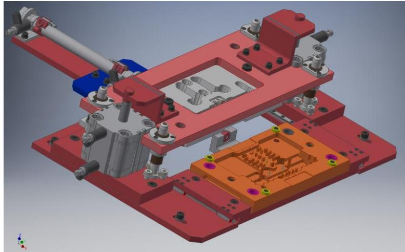
Slika 4.8 Naprava s fiksiranim kalupima za zavarivanje
