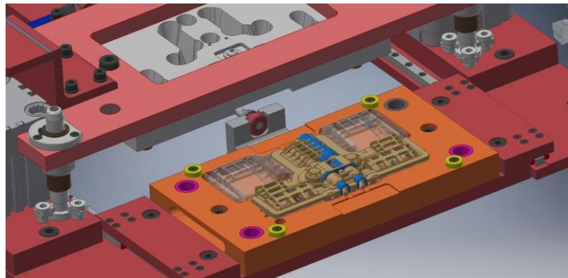
Slika 4.9 Plastike složene u kalup prije zavarivanja
