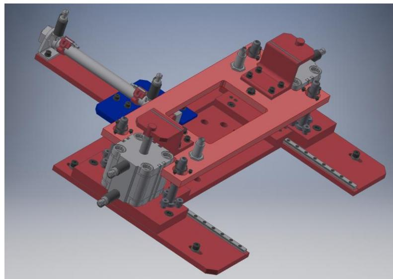
*Slika 4.7 Naprava za prihvati kalupa za zavarivanje*
