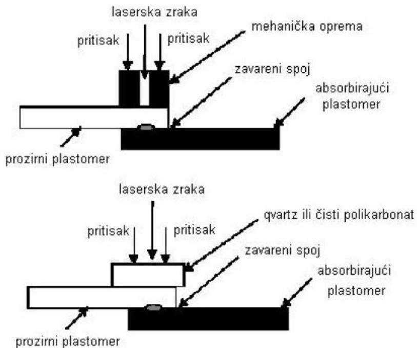
Slika 4.2 Metode pritiskanja spoja kod transmisijskog zavarivanja [7]
