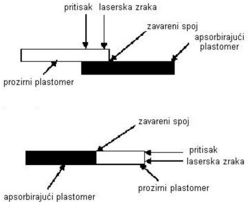
Slika 4.1 Primjer spojeva kod transmisijskog zavarivanja [7]
