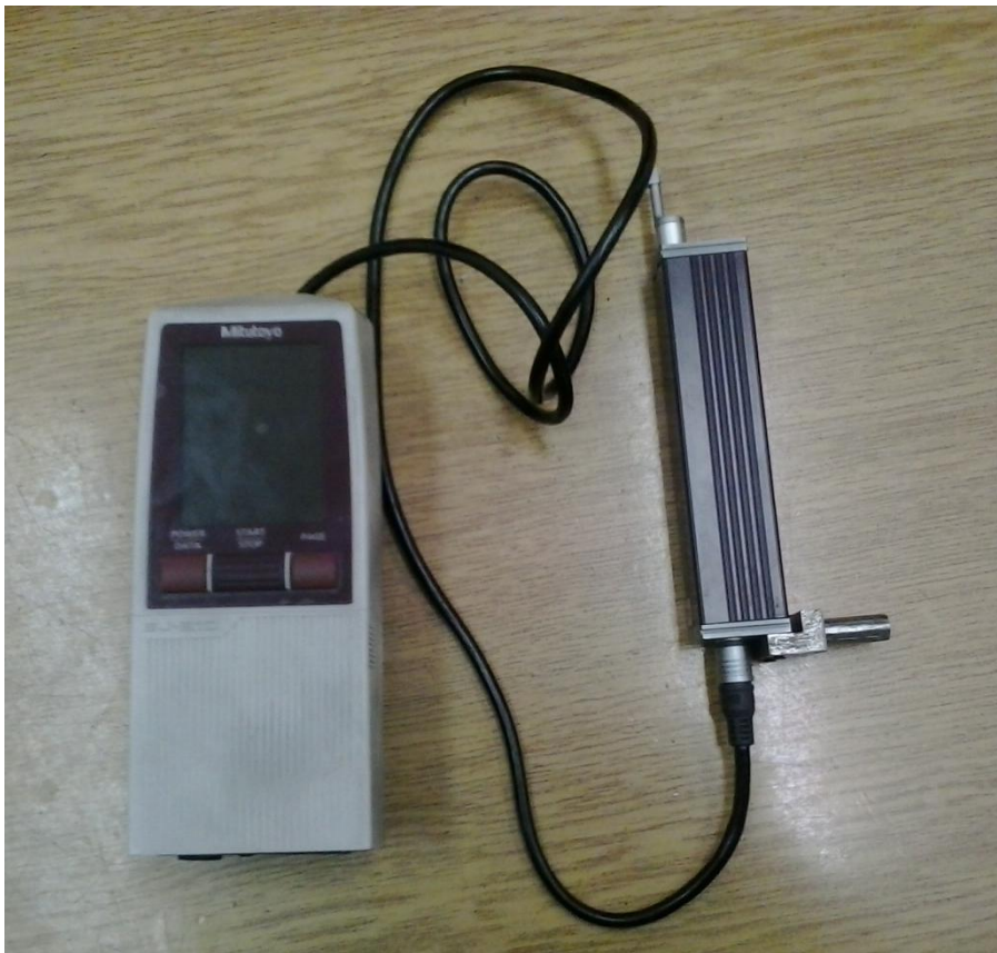
Slika 6.1.2. Uređaj za mjerenje hrapavosti SJ-210[5]
