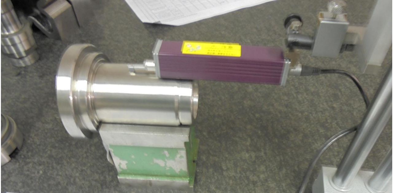
Slika 7.1.1 Mjerenje hrapavosti tokarene površine
