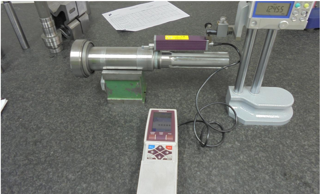
Slika 7.3.1. Prikaz mjerenja površinske hrapavosti vretena
