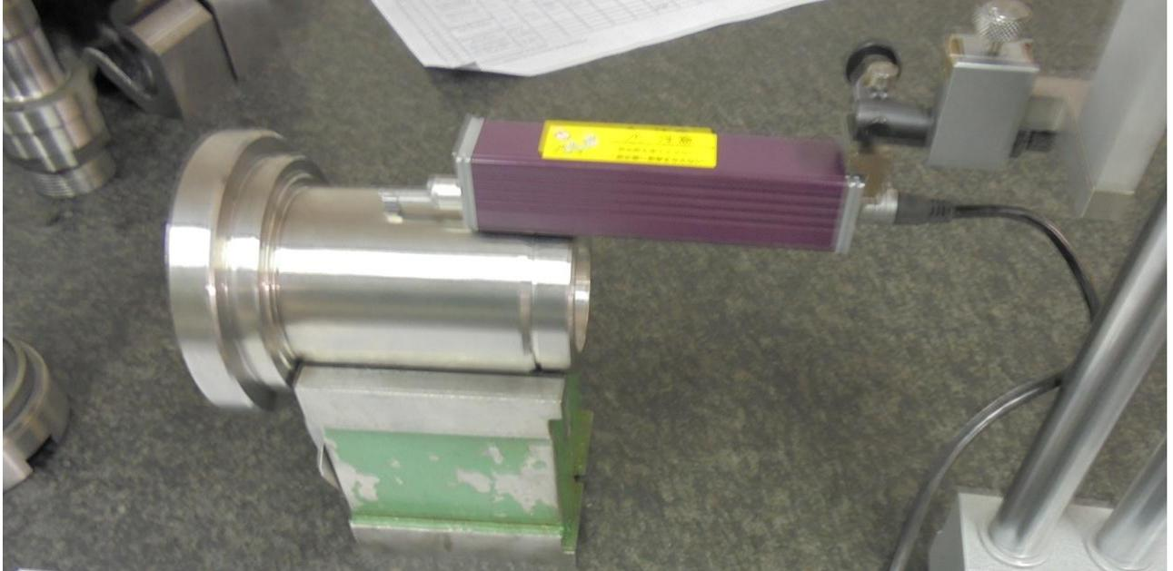
**Slika 7.1.1** Mjerenje hrapavosti tokarene površine
