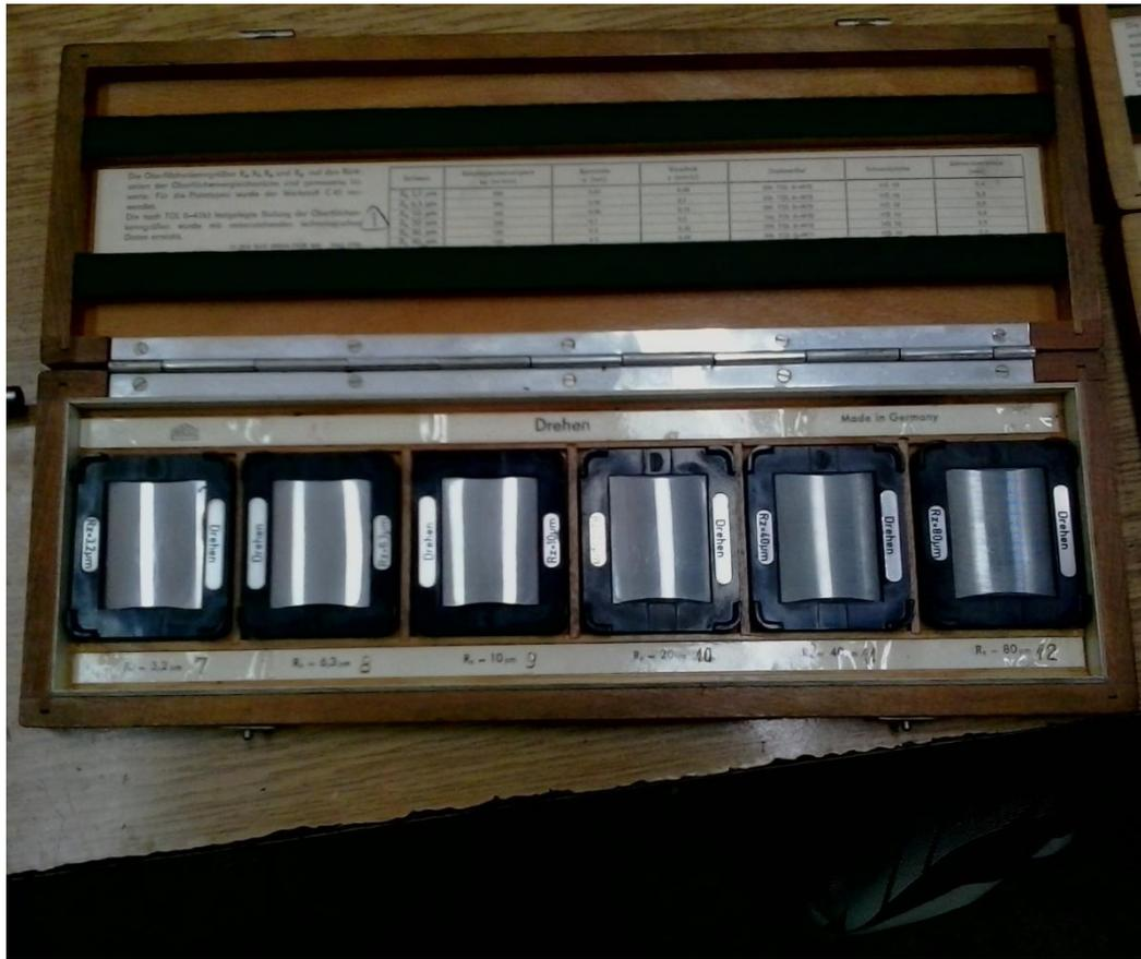
Slika 6.2.1. Set etalona za kalibraciju kod tokarenja
