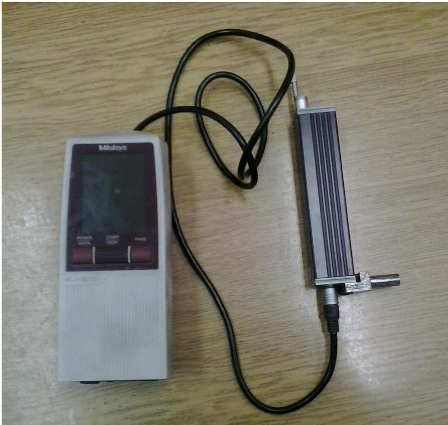
**Slika 6.1.2.** Uređaj za mjerenje hrapavosti SJ-210[5]
