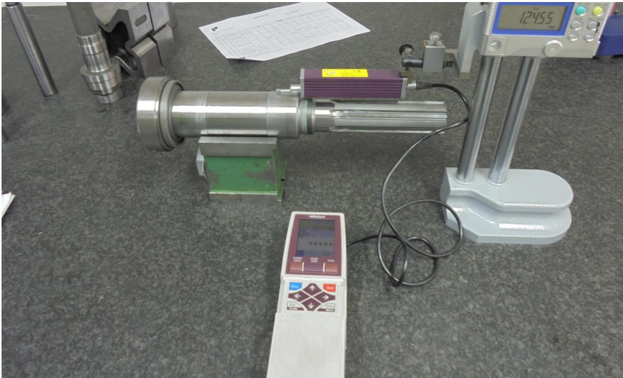
Slika 7.3.1. Prikaz mjerenja površinske hrapavosti vretena
