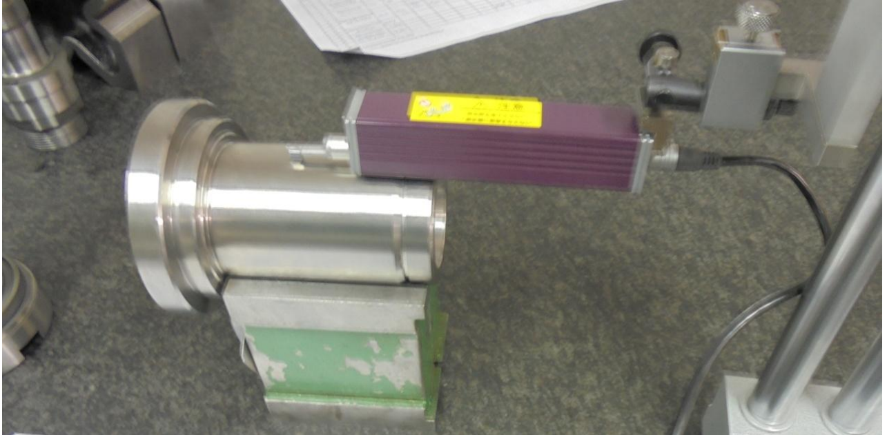
Slika 7.1.1 Mjerenje hrapavosti tokarene površine
