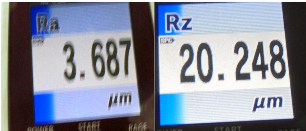
Slika 7.2.3. Slika prikazuje izmjerene parametre glodanja
