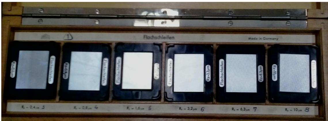
Slika 6.2.2 Set etalona za kalibraciju kod brušenja
