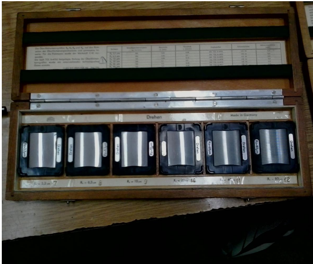
Slika 6.2.1. Set etalona za kalibraciju kod tokarenja
