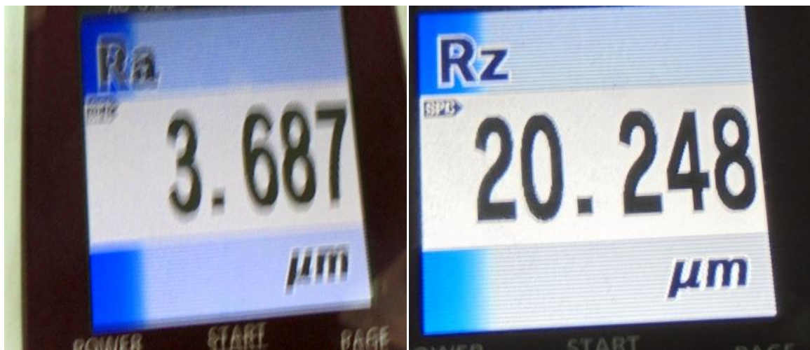
Slika 7.2.3. Slika prikazuje izmjerene parametre glodanja
