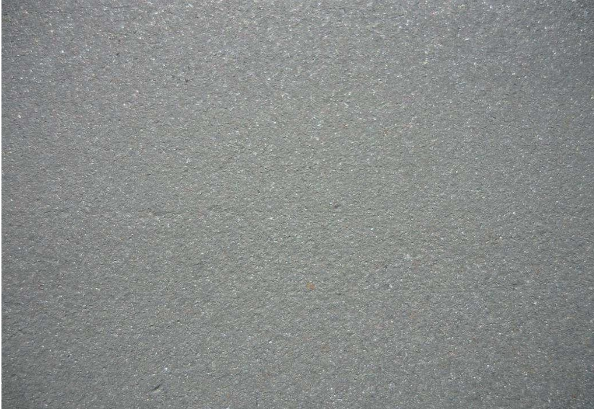
Slika 31 - Pjeskareni čelik do stupnja Sa 2½ prema HRN EN ISO 8501-1
