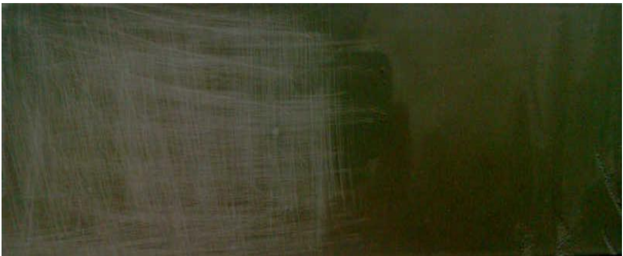
Slika 37 - Razlika između brušene i nebrušene metalne površine
