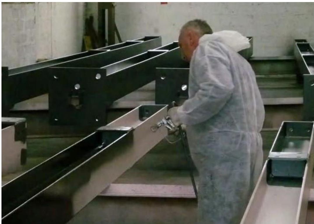
Slika 48 - Nanošenje premaza – špricanje
