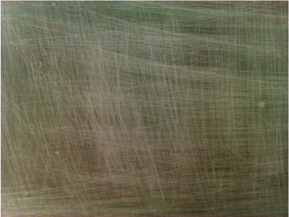
Slika 36 - Brušena / Aktivirana premazana površina (brusni papir br. 120)
