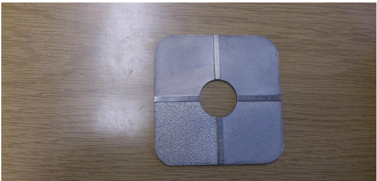
Slika 23 - Komparator za određivanje profila površine
