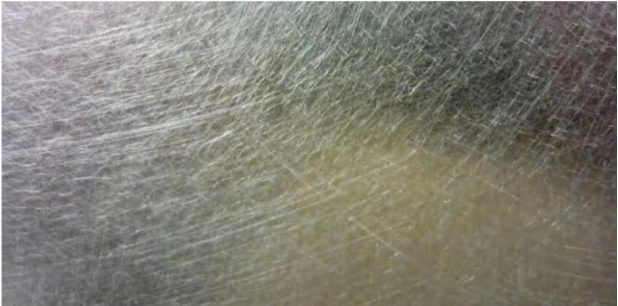
Slika 27 - Pripremljena površina - obrušeno
