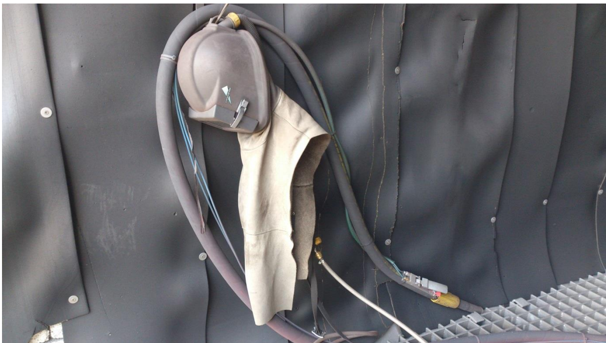
Slika 29 - Pištolj i zaštitna maska za pjeskarenje
