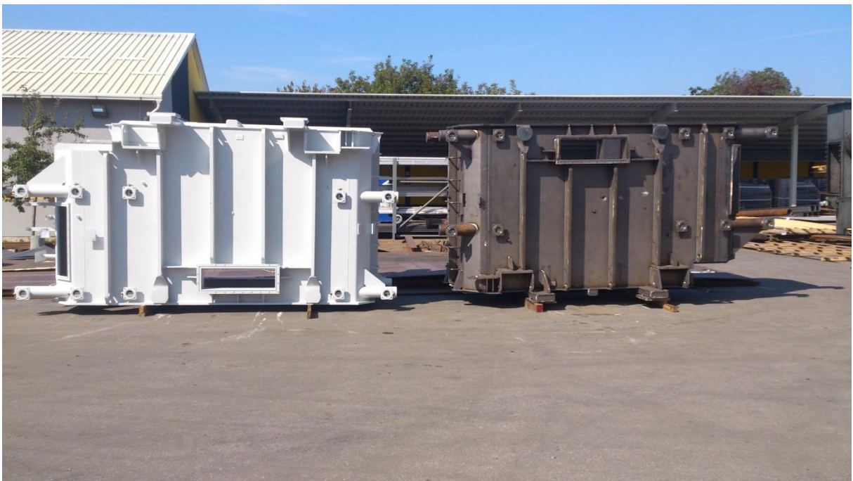
Slika 53 - Prikaz transformatorskog kotla (spremnog za dostavu) nakon i prije obrade
