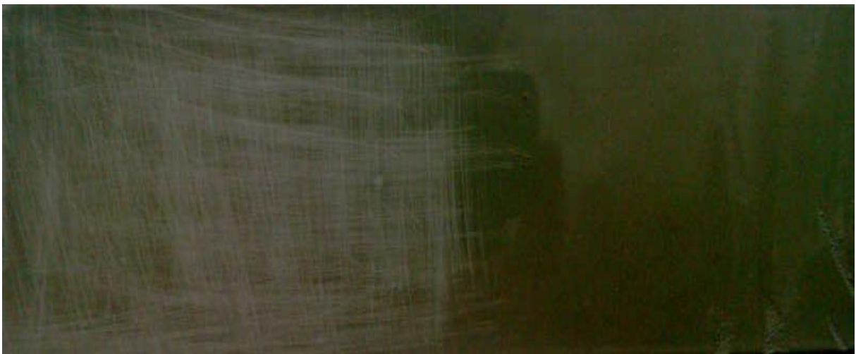
Slika 37 - Razlika između brušene i nebrušene metalne površine
