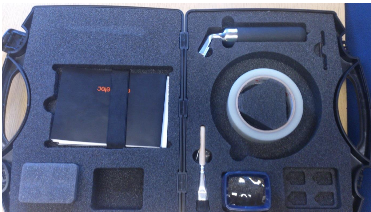
Slika 49 - Elcometar 107 - Zarezivač za provjeravanje prianjanja premaza
