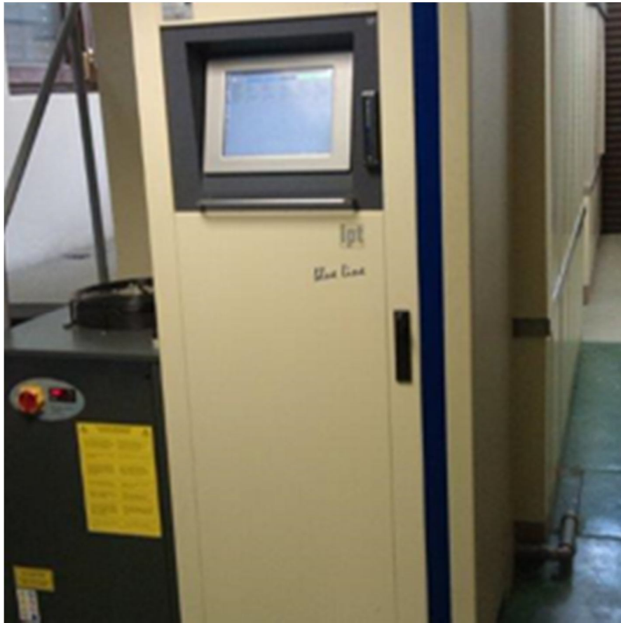
Slika 4-2. Upravljačka jedinica uređaja za ispitivanje postojanosti PEHD cijevi na unutarnji tlak
