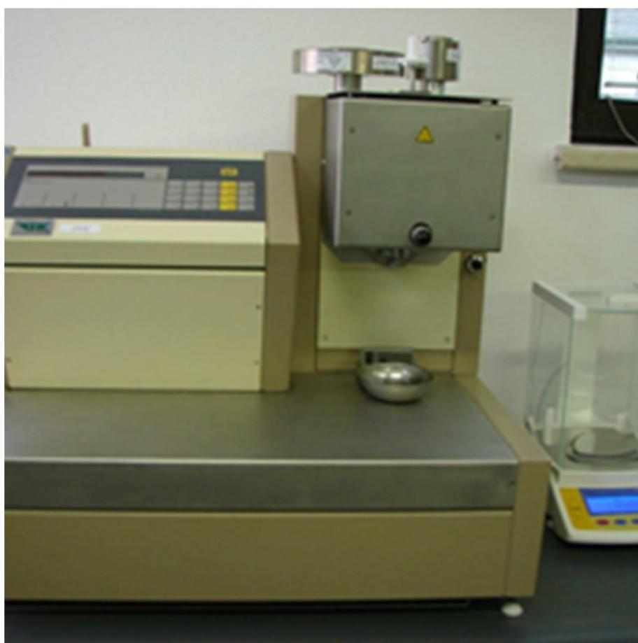
**Slika 4-1** uređaj za ispitivanje masenog protoka taljevine PEHD
