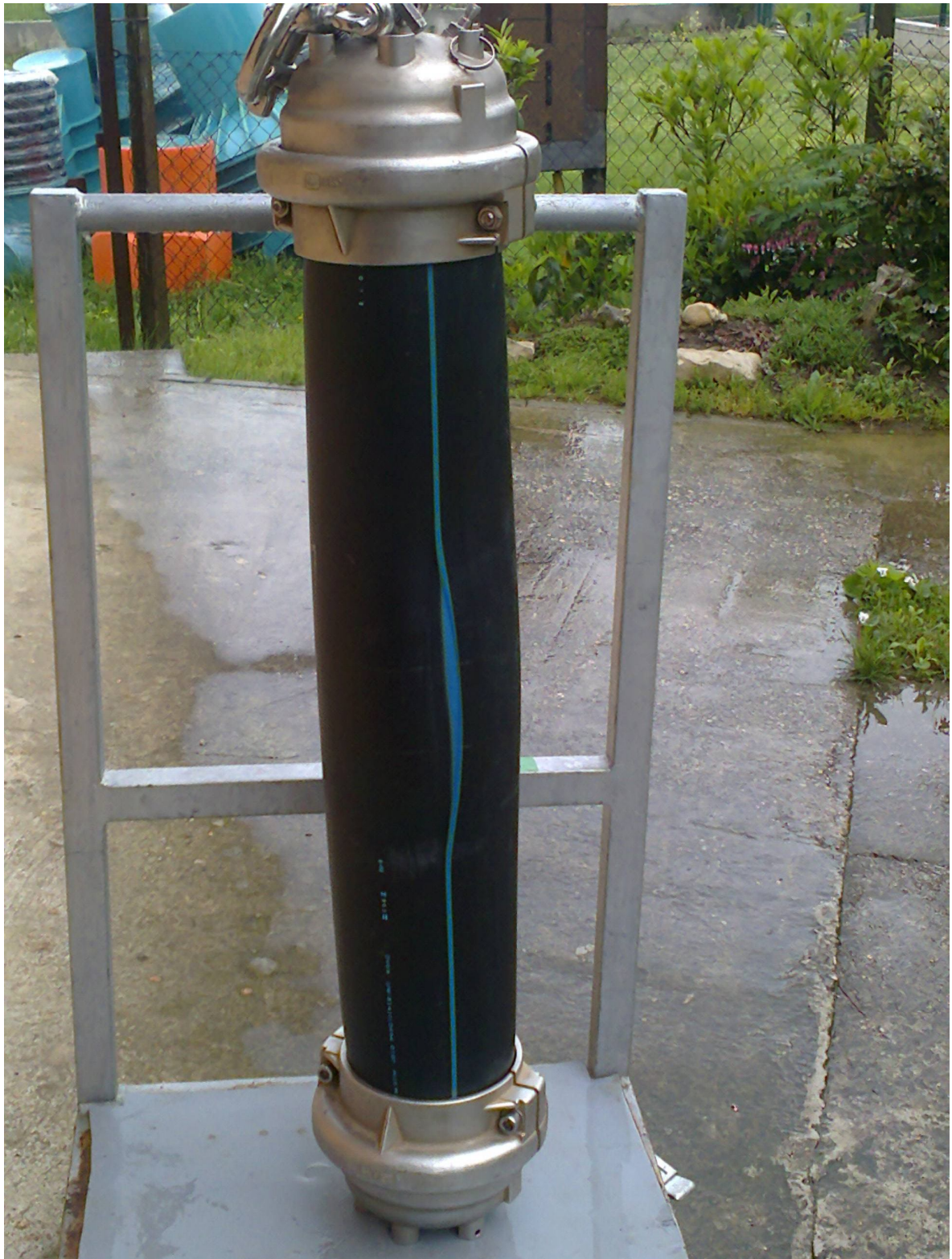
Slika 4-3 PEHD cijev ispitana na postojanost na unutarnji tlak
