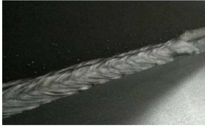
Slika 2.25 Onečišćenje kapljicama metala (602)[5]
