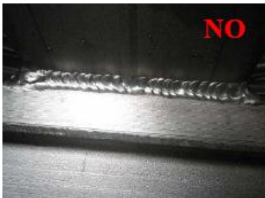
Slika 2.22 Neravnomjerna površina zavora (514) [14]
