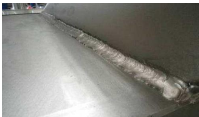
Slika 2.13 Ugorine po cijeloj dužini zavara (5011) [14]
