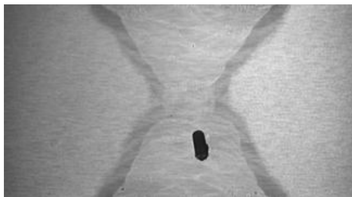
Slika 2.9 Uključak stranog metala (304)[5]
