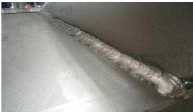
Slika 2.13 Ugorine po cijeloj dužini zavara (5011) [14]
