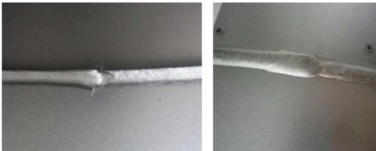
Slika 2.24 Nepravilno izveden nastavak zavara (517) [13]
