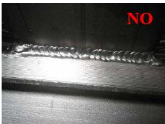
Slika 2.22 Neravnomjerna površina zavora (514) [14]
