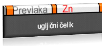
Slika 3.4. Anodna prevlaka cinka na željezu
