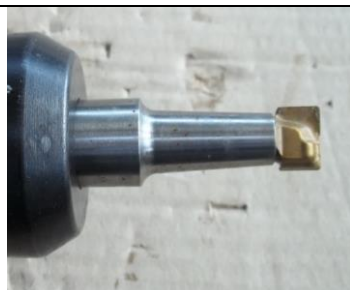
T108 Minimaster glodalo D=14 Grubo glodanje zubi
