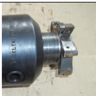
T76 Prsten.glodalo D63x15.27 Glodanje vodilice podnožne pločice
