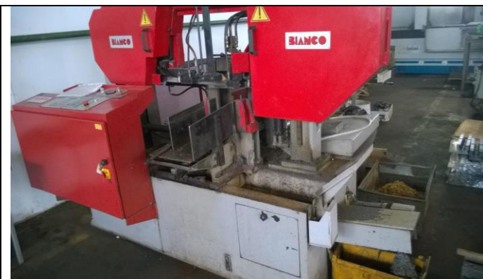
Slika 4.2 Tračna pila Bianco CNC 320
