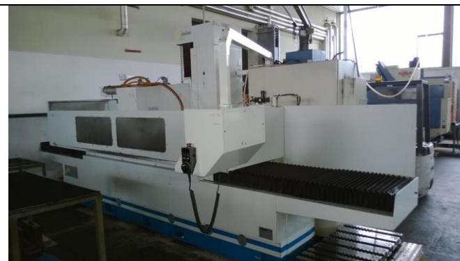
Slika 4.8 Planska brusilica Minini M2000
