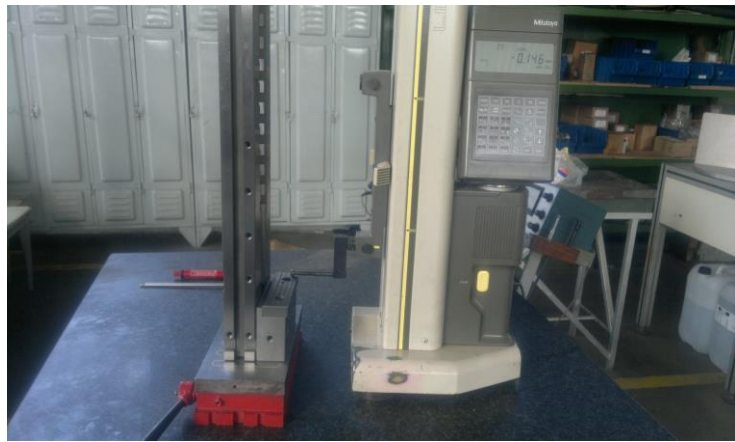
Slika 5.4 Mjerenje udaljenosti dosjeda rupa i čeljusti
