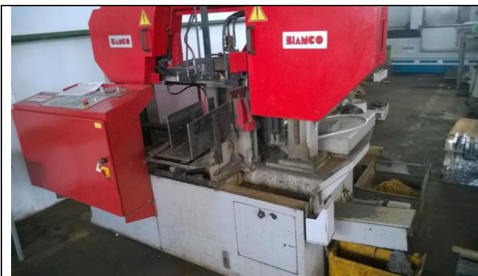
Slika 4.2 Tračna pila Bianco CNC 320
