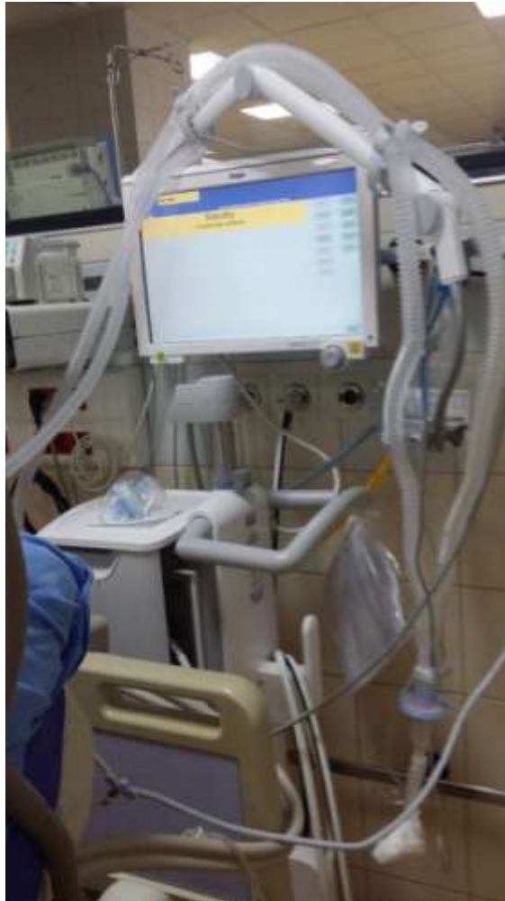
slika 2.1. Prikaz aparata za mehaničku ventilaciju; Autor: S.NJ
